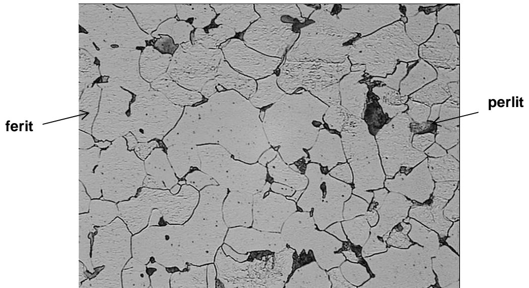
Obr. 2 Mikroštruktúra feriticko- perlitickej ocele, obsah uhlíka okolo 0,06%
