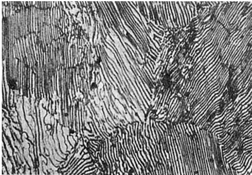
Obr. 6 Mikroštruktúra perlitickej ocele- lamelárny perlit
